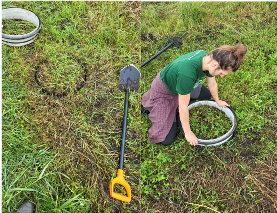
15. attēls. Statisko SEG kambaru mērīšanas riņķu uzstādīšana.
