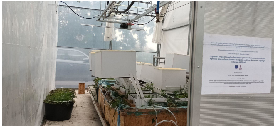
12. attēls. Ierīkots eksperiments kontrolētos apstākļos, priekšplānā SEG automatizētās kastes SEG mērījumiem, fonā augsnes vannas ar statiskajām kamerām SEG un NO 2 mērījumiem.
