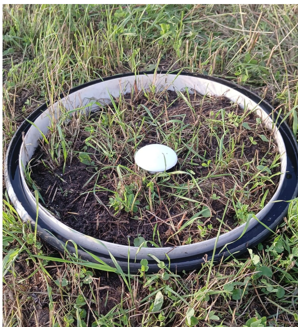
16. attēls. Statistisko SEG kambaru augsnes riņķis ar vidū ievietoto augsnes mitruma un temperatūras sensoru.
