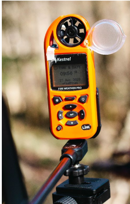
Ketel lokālā metostacija un GPS uztvērējs
