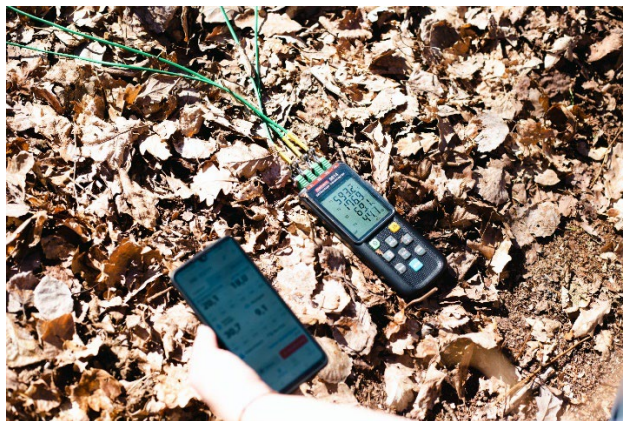
Sefran Thermometer Bluetooth ® datu ierakstu ierīce un priekšplānā redzams Ketel Fire Weather pro aplikācija laikapstākļu mērījumiem.
