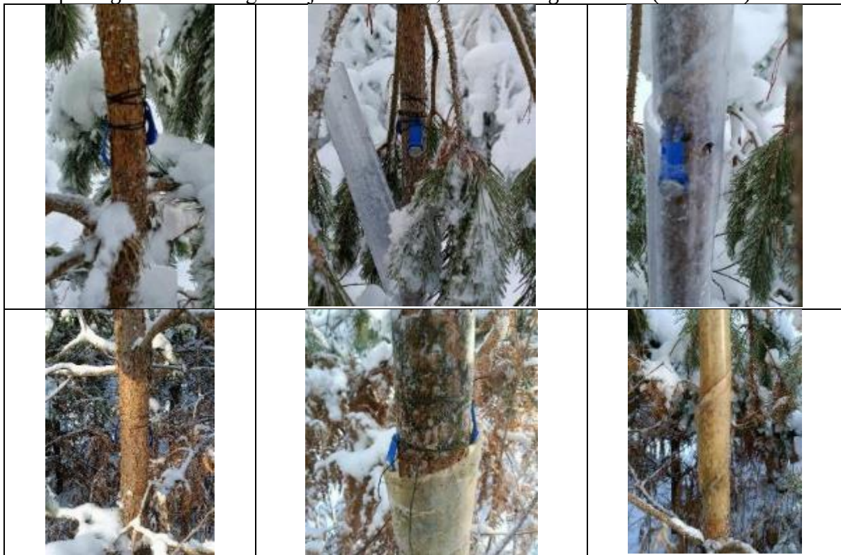
Att. 3.37. Temperatūras sensoru izvietošana kontroles un ar aizsargspirālēm aprīkotajiem kokiem. Augšējos attēlos 9 gadīgā P audzē (604-248-14), apakšējos 13 gadīgā P audzē (604-356-8)
