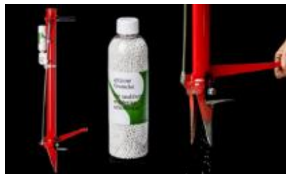
Att. 1.35. Granulēta mēslojuma/biostimulanta AG ienesei stādvietā pielāgots stādāmais stobrs https://www.skogsplantor.se/sv-se/plantor/vaxtnaring-argrow/
