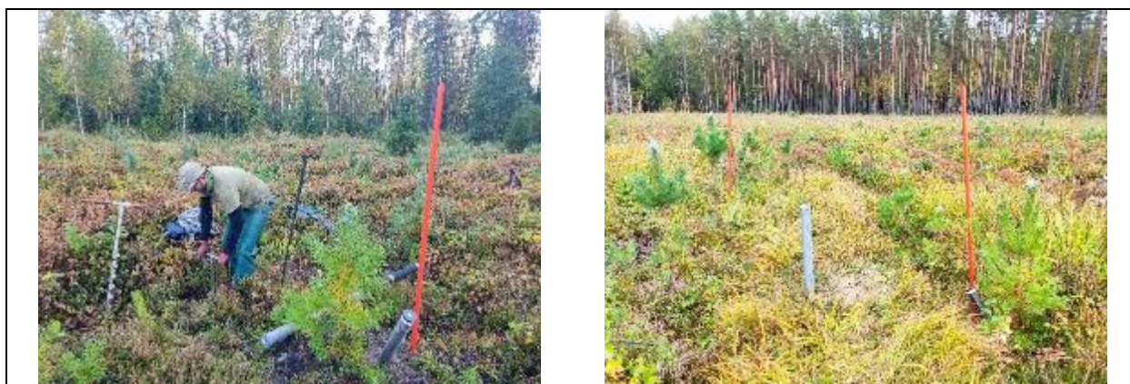
Att. 1.28. Gruntsūdens aku un sakņu cauruļu ierīkošana Lubānas iecirknī
