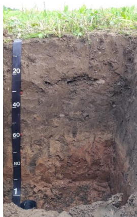
2. attēls. Koluviālā augsne “Jaņu” poligonā, Luvic PHAEOZEM (Loamic, Colluvic, Pachic) pēc PAK.
