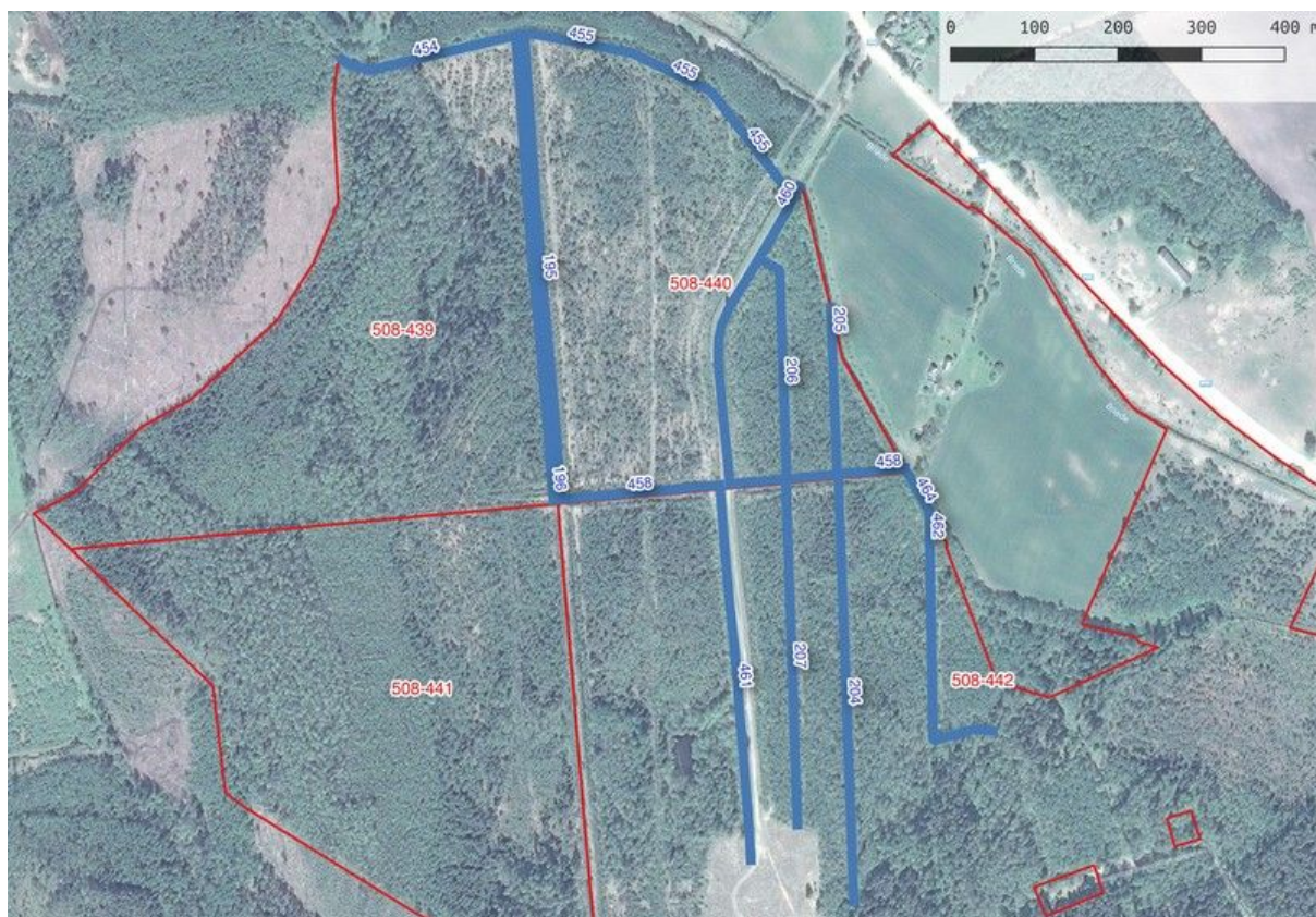
Att. 12: Izmēģinājumiem atlasītie grāvji apauguma novākšanai ar Bracke C16.b.
