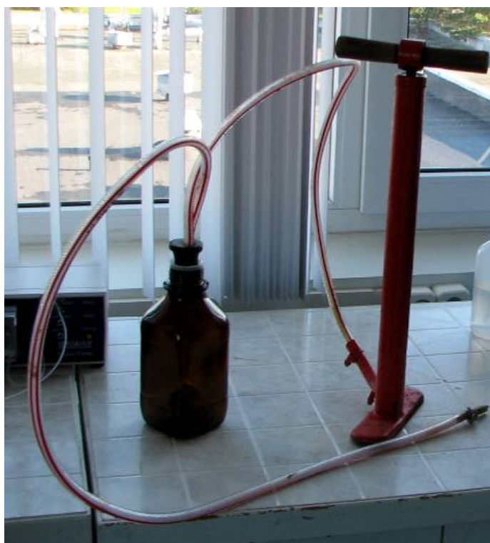
Att. 7: Sūknis augsnes ūdeņu izsūknēšanai.
