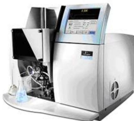
Att. 12: Atomabsorbcijas spektrometrs Perkin Elmer AAnalyst 200.
