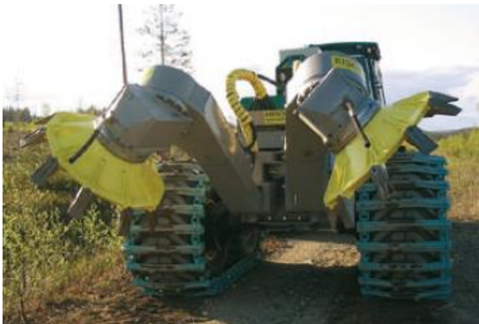
7.1. att. Bracke S35.a sējmašīna montēta uz diskveida arkla.
