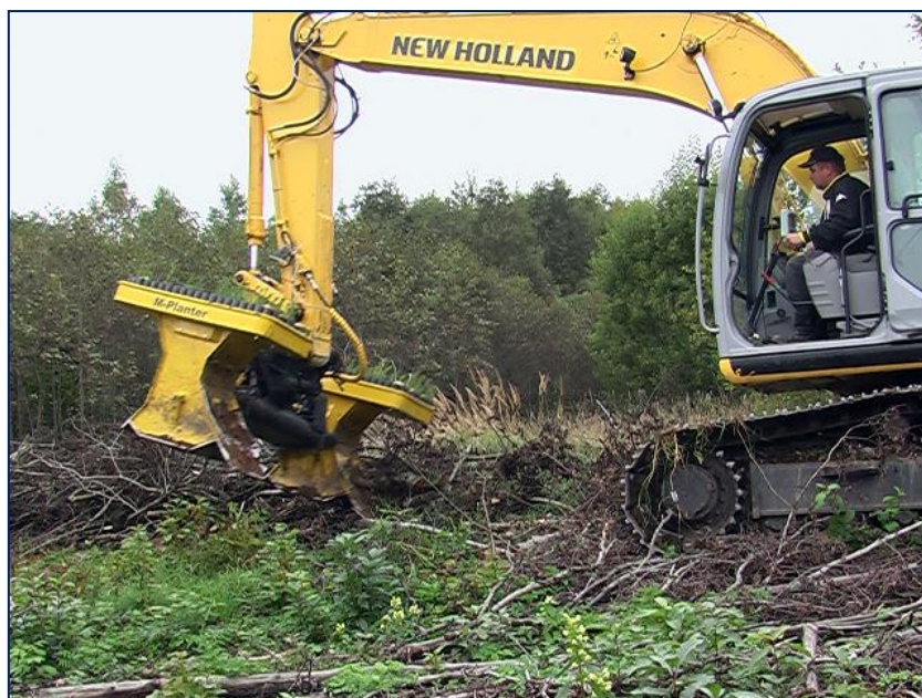
1.1. att. M-planter uz kāpurķēžu ekskavatora bāzes.
